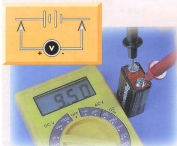
Figura 5.24. Midiendo el voltaje de salida de la batería en condiciones de circuito abierto
